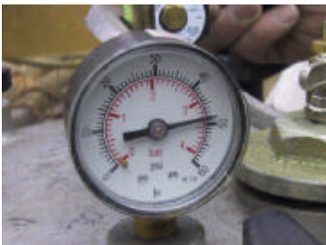
Pressione di iniezione pari a 3,5 bar
